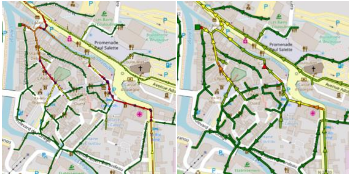
Figure 4 – Effets de la réduction de la surface active sur les surcharges à Ax-centre
