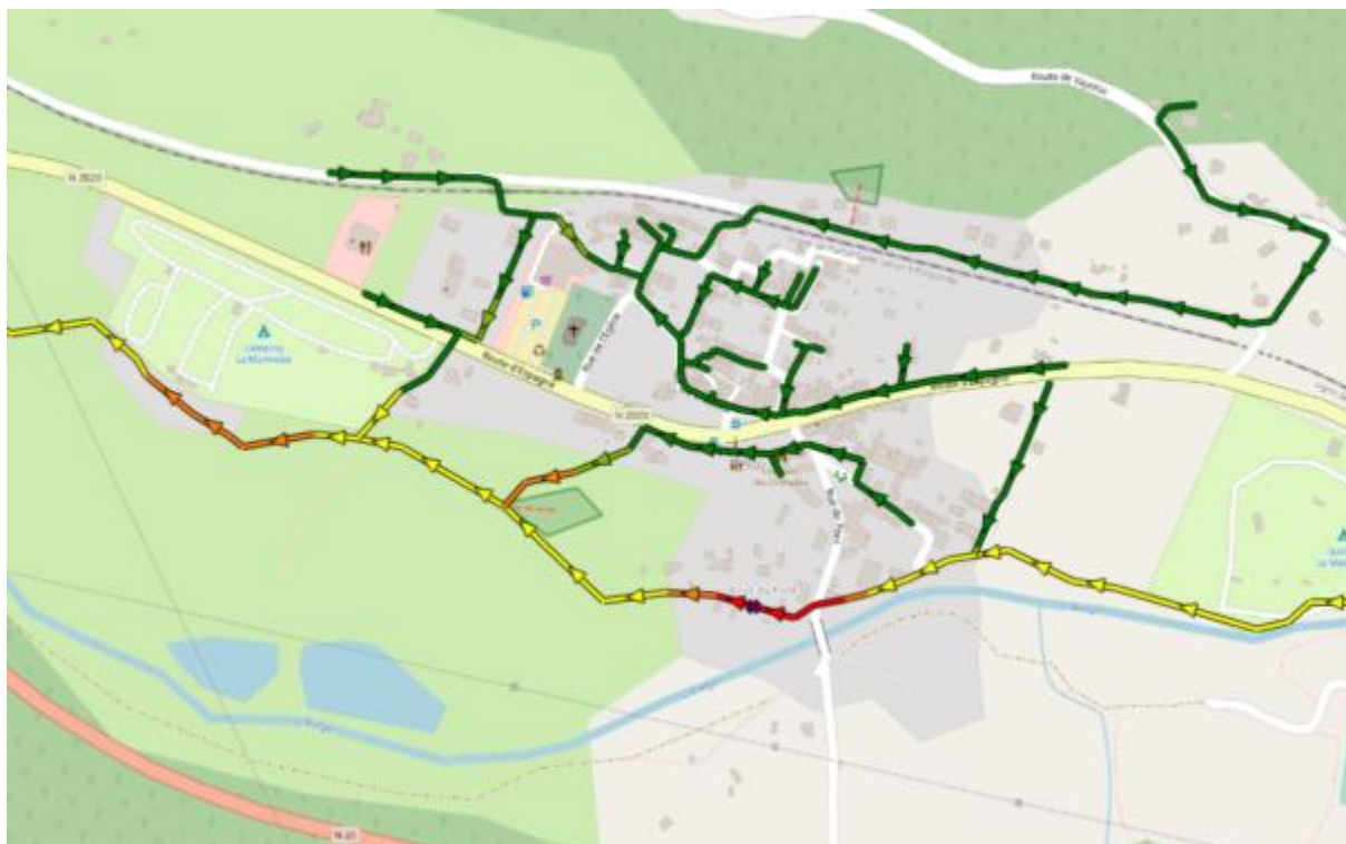
Figure 21 – Illustration des surcharges de temps sec sur le collecteur principal à Savignac
