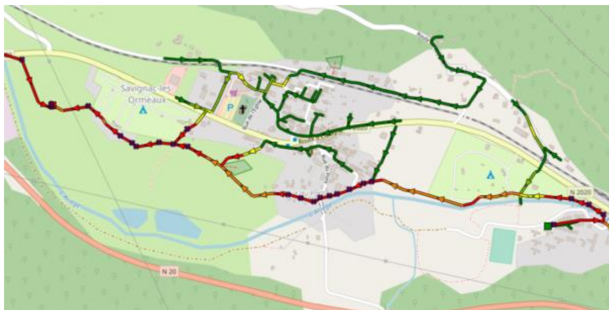
Figure 11 – Illustration des surcharges sur le collecteur principal à Savignac
