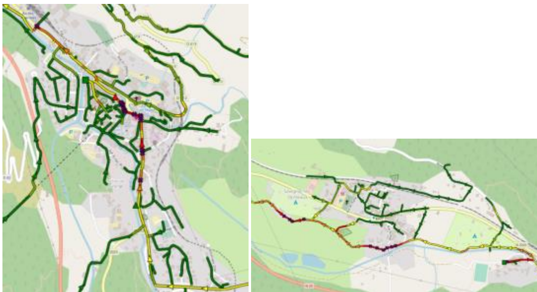
Figure 14 – Illustration des surcharges restantes après diminution de la surface active
