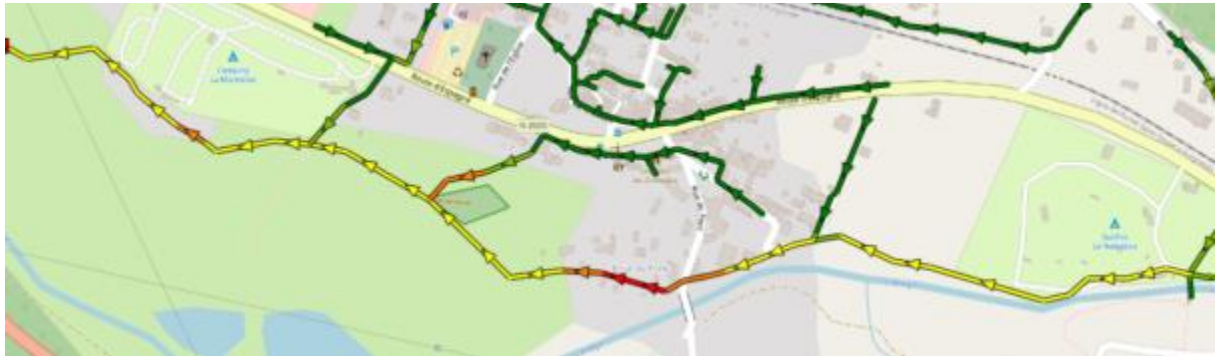
Figure 8 – illustration des charges élevées sur le collecteur principal de Savignac
