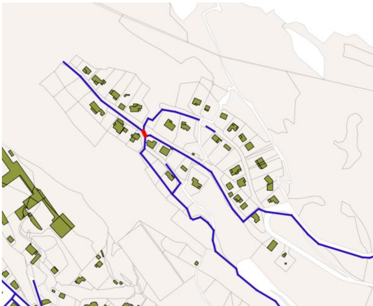
Figure 22 – Localisation des intrusions d’eaux claires parasites pour le secteur de la Calmeriaie
