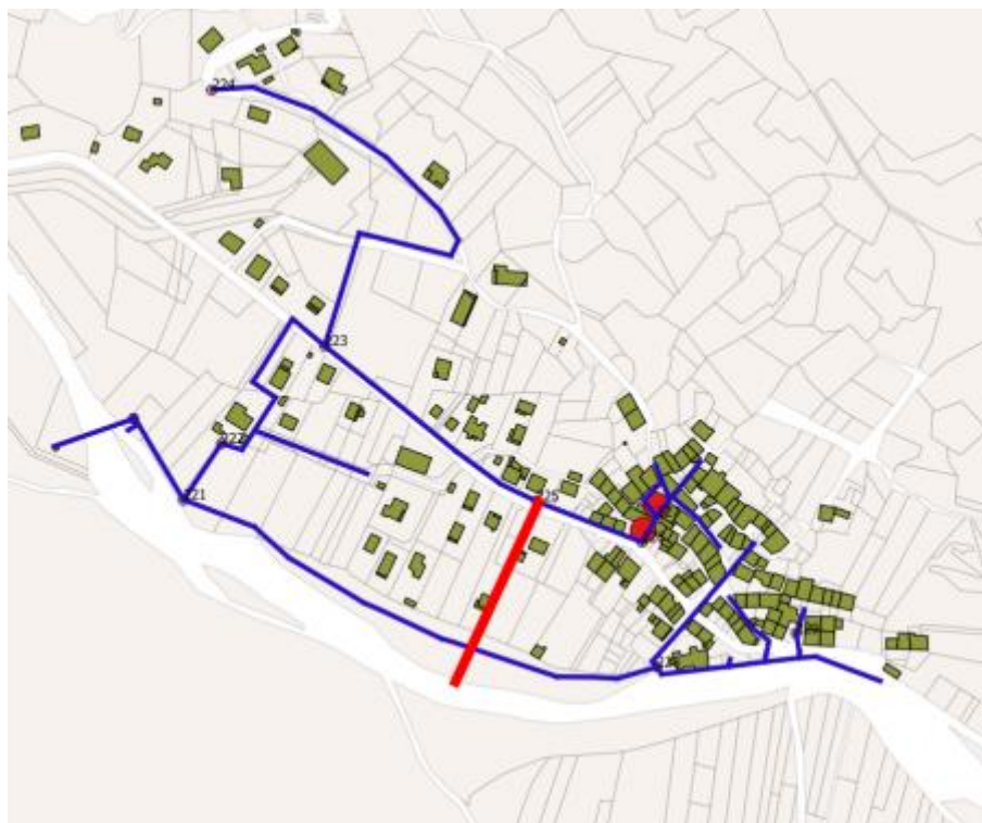
Figure 28 – Localisation des intrusions d’eaux claires parasites pour le secteur d’Orgeix-rejet direct
