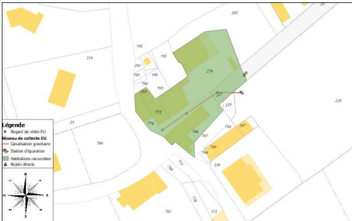
Figure 11 : Zonage de l'assainissement et des travaux à réaliser au niveau du hameau de Lanquit (scénario 3.2)
