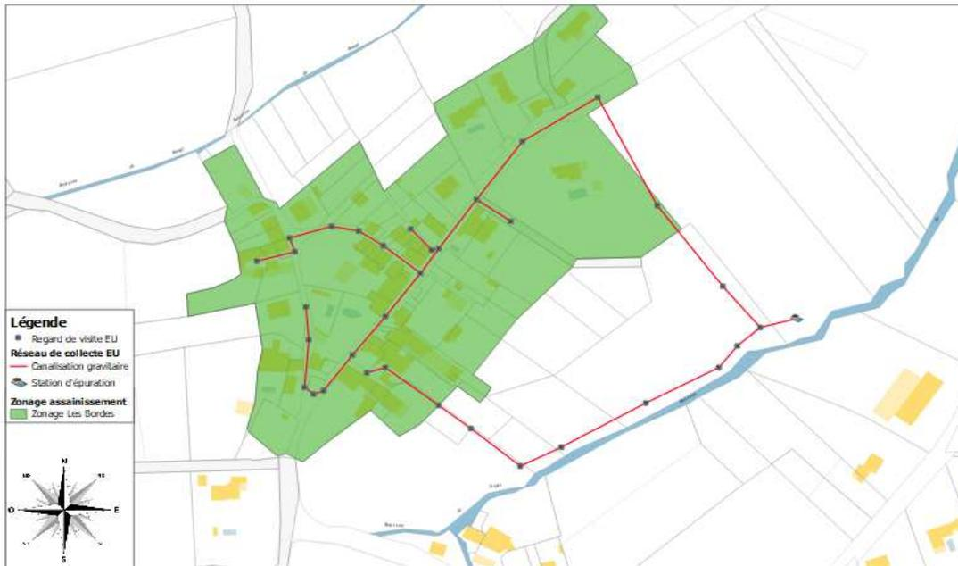
Figure 6 : Zonage de l'assainissement et des travaux à réaliser au niveau du hameau des Bordes (scénario 2.1)
