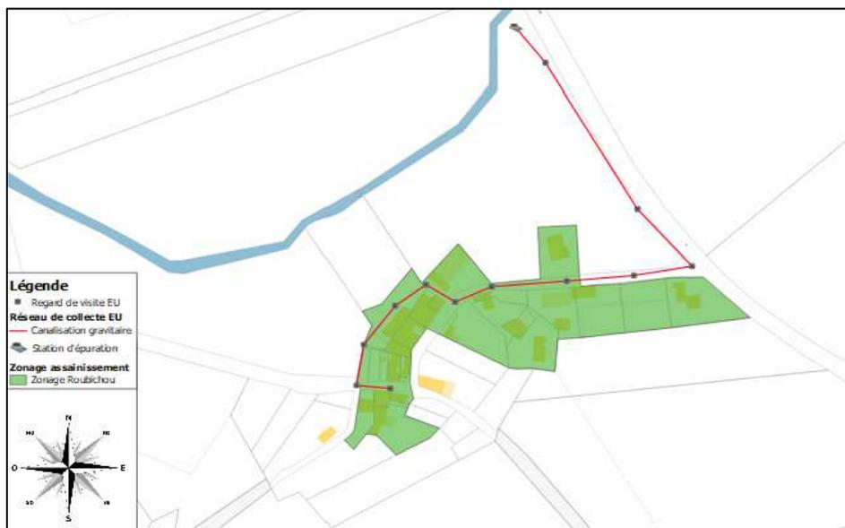
Figure 8 : Zonage de l’assainissement et des travaux à réaliser au niveau du hameau de Roubichou (scénario 2.3)
