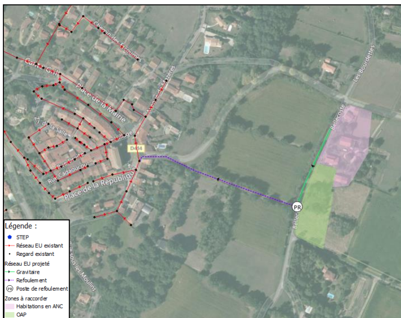
Figure 1 - Scénario d'extension du réseau d'assainissement
