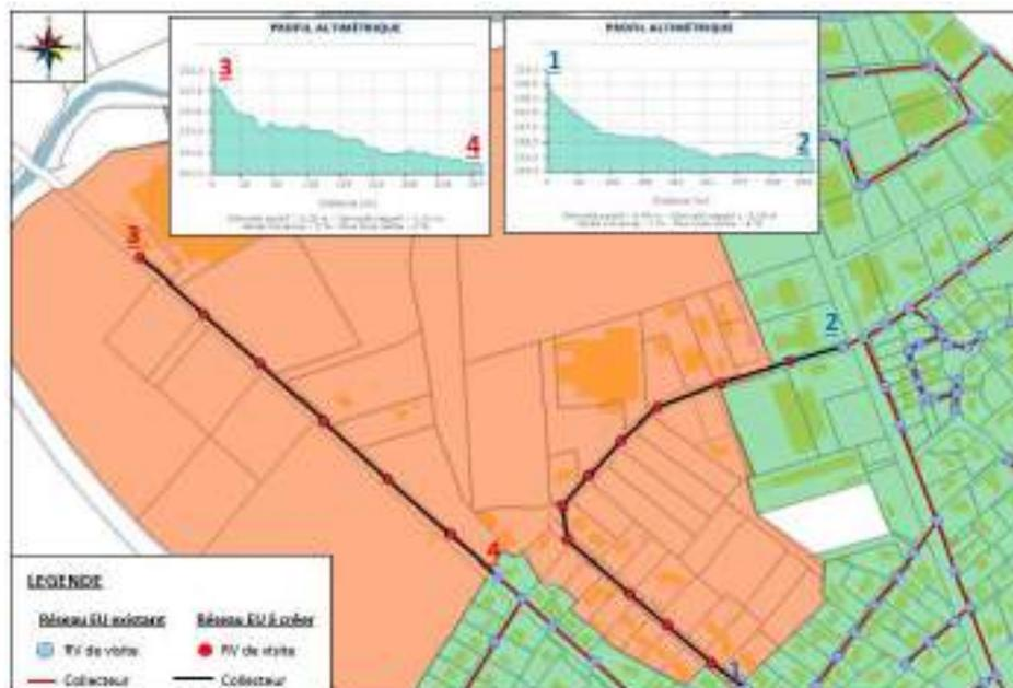
*Figure 8 : Tracé potentiel du raccordement au réseau d'assainissement existant*
