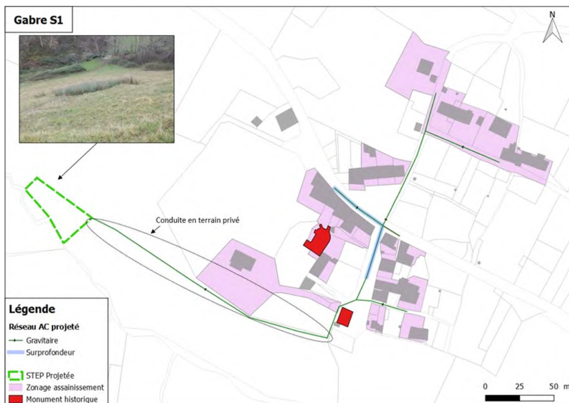
Fig. 26. Scénario 1 – Collecte des effluents du Village de Gabre
