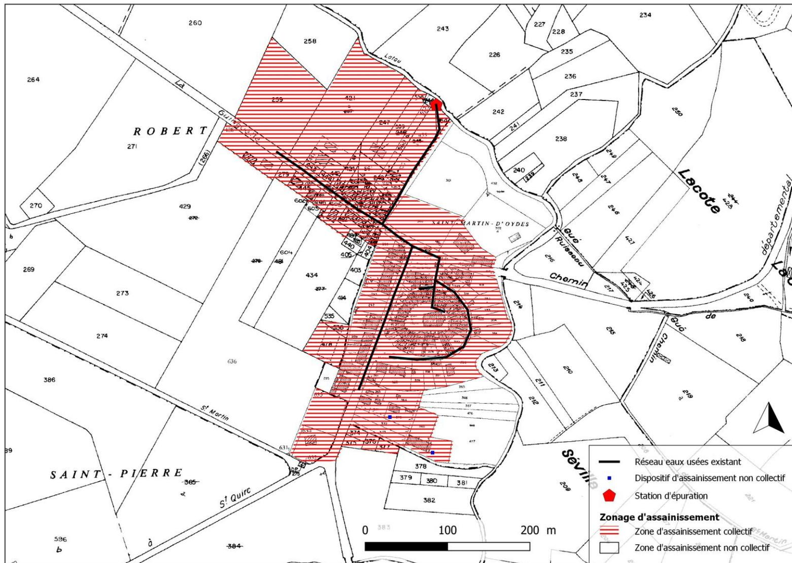
**FIGURE 10 : SUPERPOSITION DU ZONAGE D'ASSAINISSEMENT PROPOSE ET DU RESEAU D'ASSAINISSEMENT COLLECTIF**
