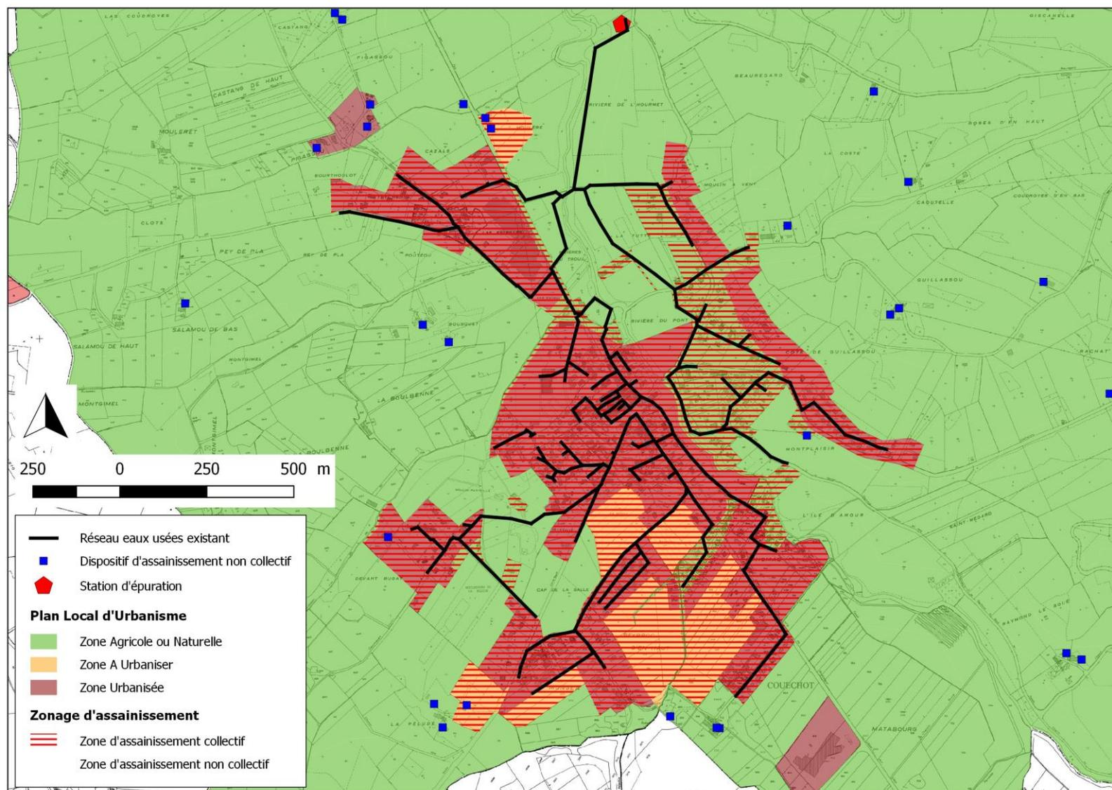
**FIGURE 9 : SUPERPOSITION DU ZONAGE D'ASSAINISSEMENT COLLECTIF PROPOSE ET DU PLAN LOCAL D'URBANISME**
